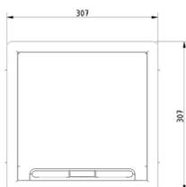
Klappdeckel ausgestattet mit zwei Kabelausslässen und integriertem Öffnungshebel.
