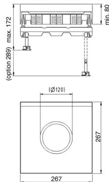
Einbaurahmen + Klappdeckel + wasserdiichter Kabelausslass + Alurahmen + Tubus Deckelschlüssel
