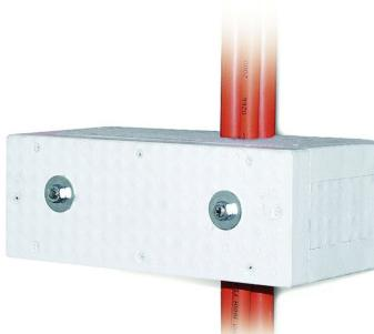
Soutien efficace pour installation verticale à utiliser à des intervalles jusqu'à 3,5m avec DR15.30 rail et attaches HDH1. Une installation de câble en forme de méandre n'est pas nécessaire.
